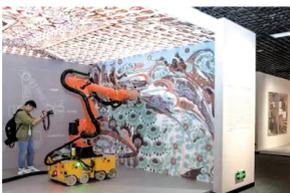
家重点项目之一“墓葬壁画原位保护关键技术研究”。五院529厂应邀承担能够搭载高能电子束辐照灭菌装置的移动式消杀装备。研制团队克服了壁画本体脆弱、墓室甬道狭小、穹顶结构复杂、地下湿度高、地面凹凸不平等应用环境难题,圆满完成研制任务,实现了可移动机器人装备研制技术在文物保护和智能检测及消杀领域的延伸应用。
